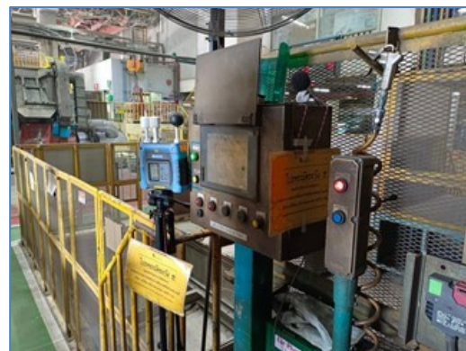
ภาพที่ 3.10 ภาพแสดงการตรวจวัดระดับความร้อนภายในพื้นที่ทำงาน
