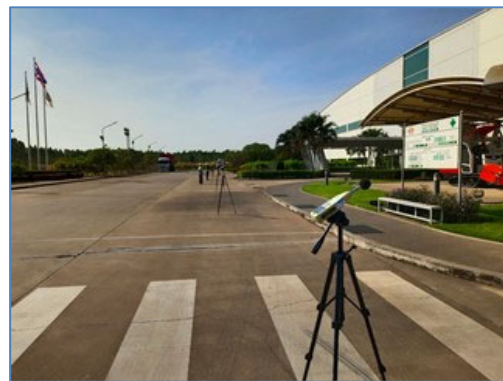
ภาพที่ 3.12.2 ภาพแสดงการตรวจวัดระดับเสียงในพื้นที่ทำงานเพื่อจัดทำ Noise contour map
