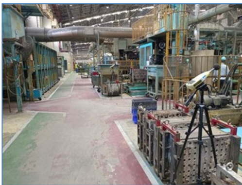
ภาพที่ 3.12.2 ภาพแสดงการตรวจวัดระดับเสียงในพื้นที่ทำงานเพื่อจัดทำ Noise contour map
